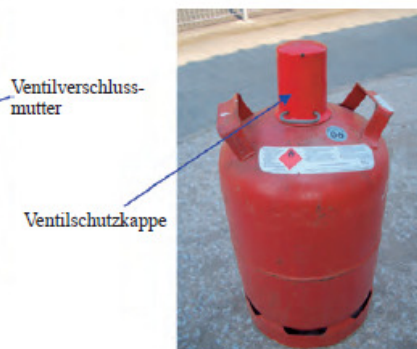
Abb. 31: Flüssiggasflasche mit Ventilschutzkappe
