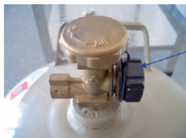
Abb. 30: Flüssiggasflaschen-Absperrventil mit aufgeschraubter Ventilverschlussmutter
